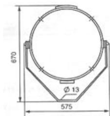
Прожектор ПЗС-45 заливающего света со стеклянным отражателем.
