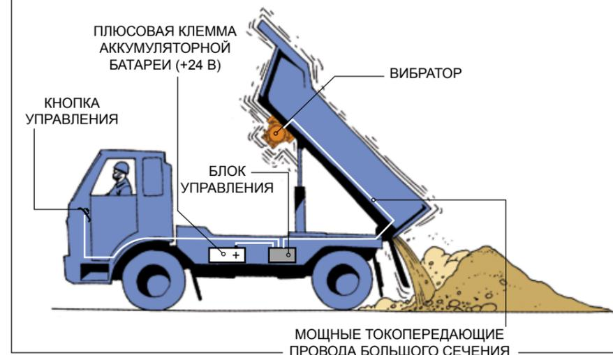
Автомобильный вибратор – частный случай применения автономного вибратора.
